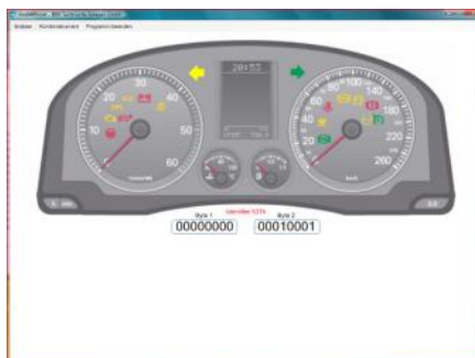
Abbildung zeigt die Nachbildung des Kombiinstrumentes mit Anzeigen
