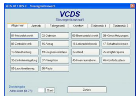
PC-Software zum Auslesen der Eigendiagnoseschnittstelle des Zentralsteuergerätes.
