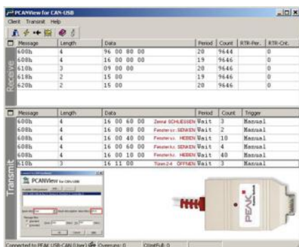
PC-Software zu Auslesen der CAN-Botschaften und zum Absetzen von CAN-Befehlen.
